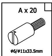
! Trekk til skruene ca 80% slik at stangen fortsatt kan beveges.
