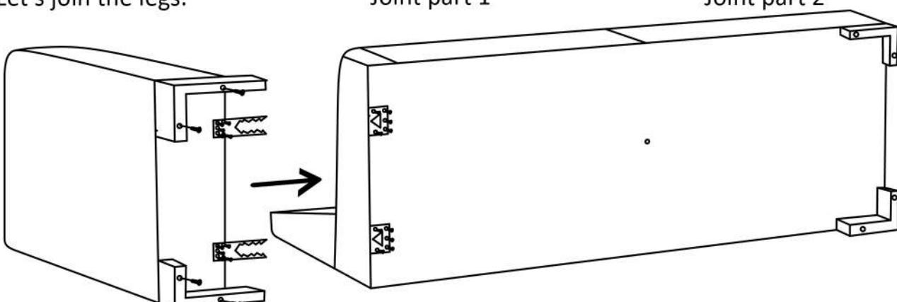
Kol ile modül kısmı birleşiminde kol altındaki çıkıntılı ayak bağlanan modülün altına girecektir. /
